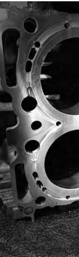
**LV** Hard Core Racing specifiski apstrādā Subaru, Mitsubishi, Honda un citu ražotāju alumīnija dzinēju blokus, lai nodrošinātu motora jaudu ilgam laikam. Izmantojot augstas precizitātes CNC iekārtas, tiek radīta slēgta dzinēja bloka virsma (*closed deck*), kas nodrošina dzinēja izturību paaugstinātās jaudas un slodzes apstākļos. Hard Core Racing sniegt pakalpojumu kvalitāte balstīta ilggadējā pieredzē auto sportā un motivētā darbinieku attieksmē pret katru pasūtījumu klientiem visā pasaule.
